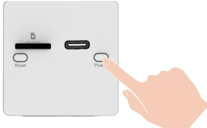
Pokud je baterie v kameře vybitá, připojte kameru pomocí napájecího adaptéru (5 V, 1 A) do elektrické zásuvky a nabijte ji (k zakoupení samostatně).
