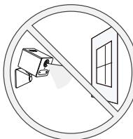
Nemontujte zařízení před skleněná okna (např. v autě).
